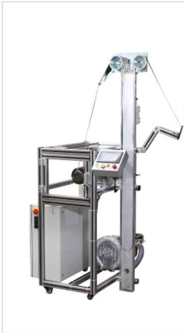
纬纱无捻退解装置 Weft untwisted unwinding device
